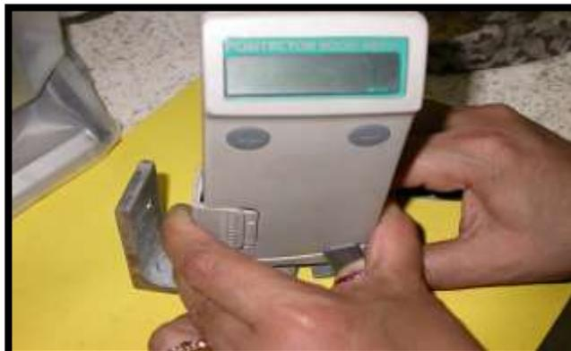
**FIGURA 2.3 MEDICION DE ESPESOR DE PINTURA EN PROBETAS**
