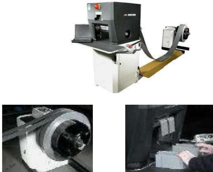
**FIGURA 2.1 MÁQUINA PARA CORTAR LA CHAPA DE ACERO
