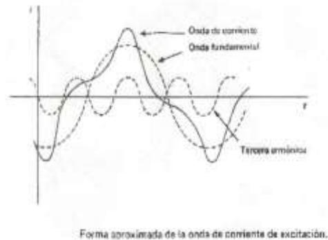
**FIGURA 2.16 COMPONENTES DE LA CORRIENTE DE EXCITACIÓN**
