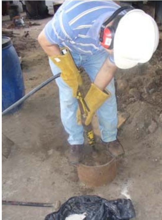
FIGURA 2.2 COMPACTADORA CON PISÓN NEUMÁTICO
