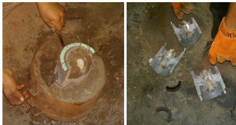
FIGURA 1.9 DESMOLDEO DE LA PIEZA
