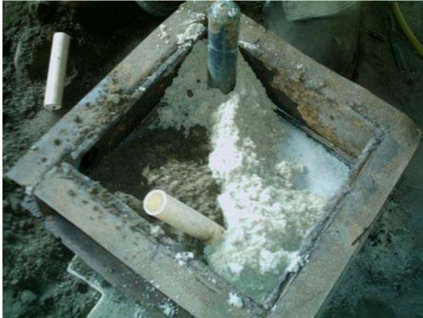
FIGURA 1.4 CAJA DE MOLDE CON VERTEDERO
