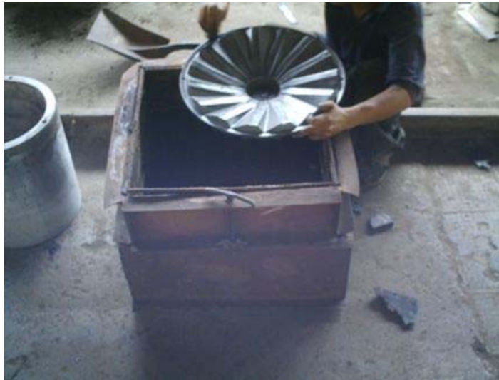
FIGURA 1.2 MOLDEO DE UNA PIEZA (DIFUSOR)
