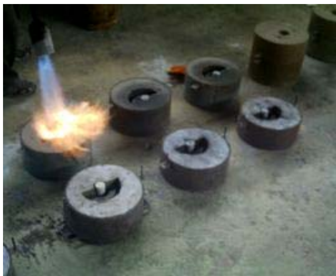
FIGURA 1.8 SECADO DE LA ARENA CON MECHERO A GAS
