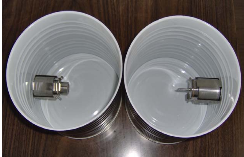
FIGURA 2.2 Vista superior de la ubicación de sensores
