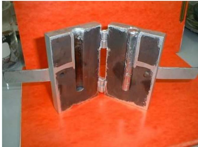
**FIGURA 2.5 PROBETA DE PRUEBA PARA ANÁLISIS QUÍMICO Y METALOGRÁFICO.**
