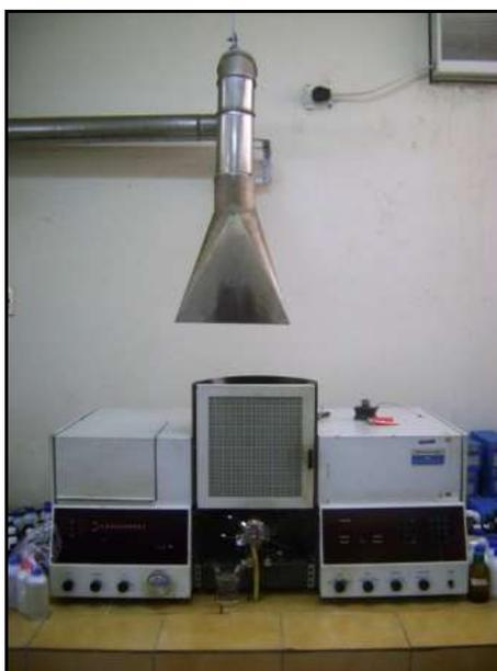
**FIGURA 2.11 ESPECTROFOTÓMETRO DE ABSORCIÓN
