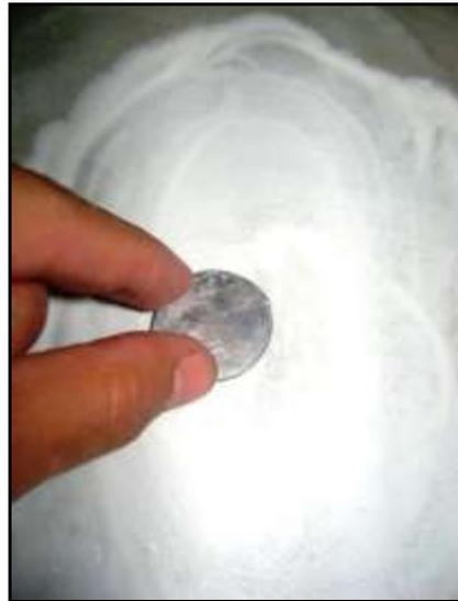
**FIGURA 2.14 PULIDO FINAL DE LA PROBETA**
