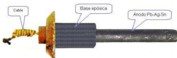
**FIGURA 1.6 ÁNODO LISTO PARA SER USADO EN
