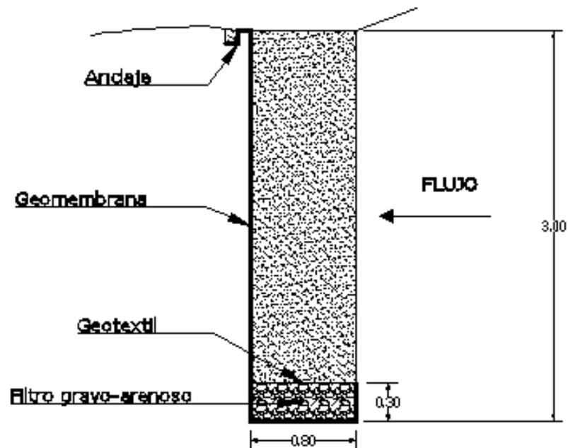
Lámina 6. Corte de pantalla de intersección de flujo
