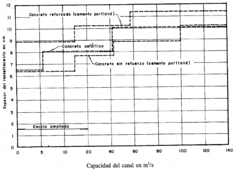
Lámina 10. Espesor de revestimientos de superficie dura en canales
