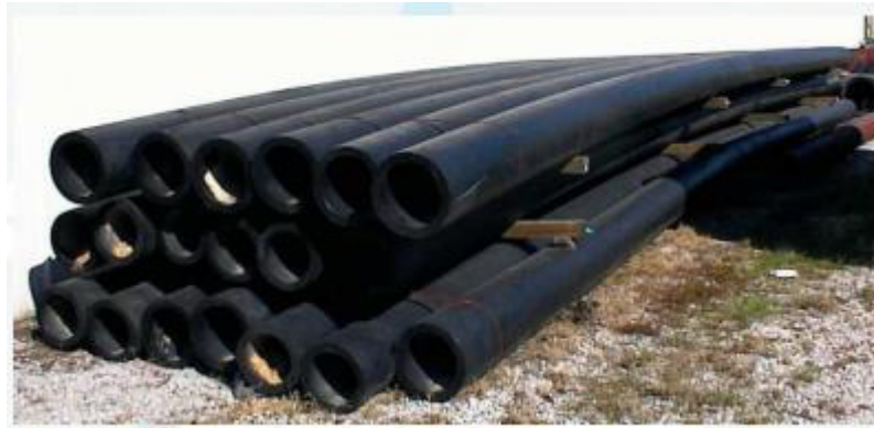
Fig. 34 Ejemplo de la tubería de descarga que será utilizada
