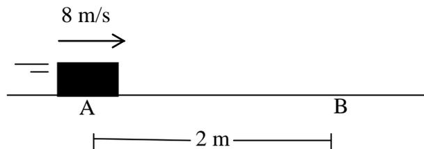
23) El carro parte del reposo en A y se desliza por la vía sin fricción. ¿Cuál es la velocidad que posee cuando pasa por B?
