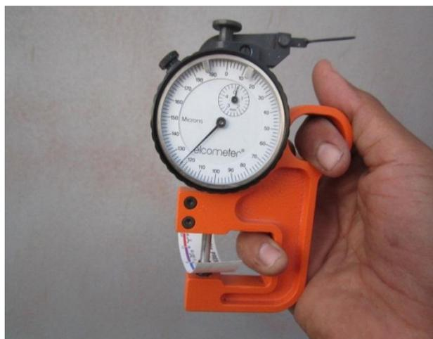
*Foto 8 Medición del Perfil de Anclaje<sup>36</sup>*
