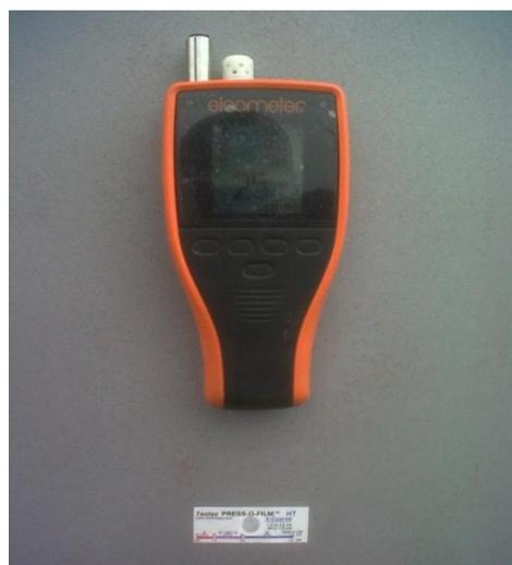
*Foto 9 Medición de Parámetros Ambientales con equipo Elcometer 227, y cinta testigo de perfil de anclaje.<sup>37</sup>*
