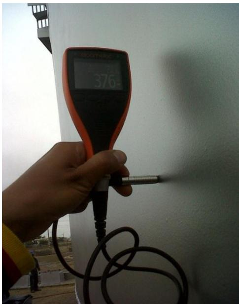
*Foto 12 Medición de Espesores en Seco. Elcometer 332 tipo sonda.<sup>42</sup>*
