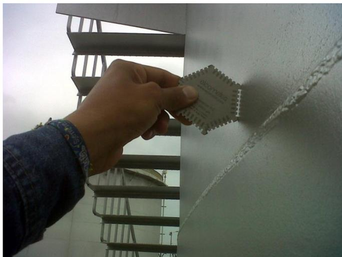
*Foto 11 Medición de Espesores en Húmedo, Elcometer 112 tipo galleta.<sup>41</sup>*
