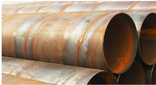
Figura 9 Tubería con corrosión
