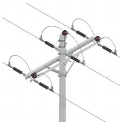
Figura 3.4: Estructura centrada de doble retención (3CD) [10].
