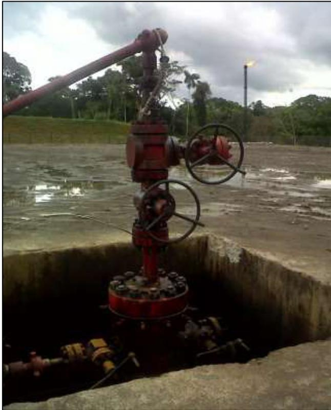
**FIGURA 2.5: Cabezal de producción del pozo AMD1
