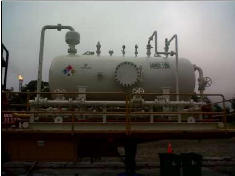
**FIGURA 2. 13: Separador trifásico en la MTU**
