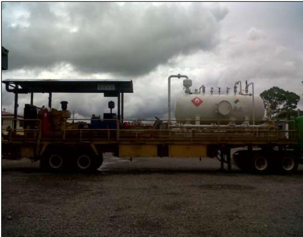
**FIGURA 2. 8: Unidad Móvil de Prueba (MTU)**
