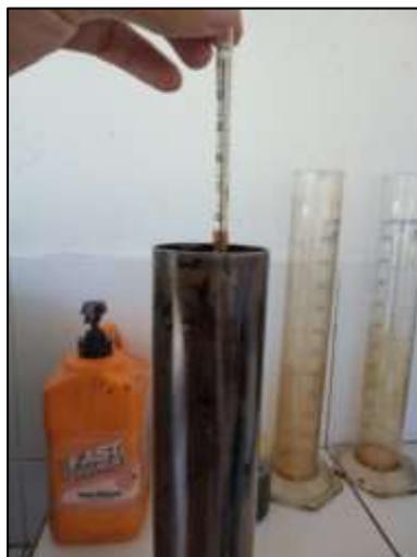
**FIGURA 2.3** Toma de la densidad del petróleo en grados API
