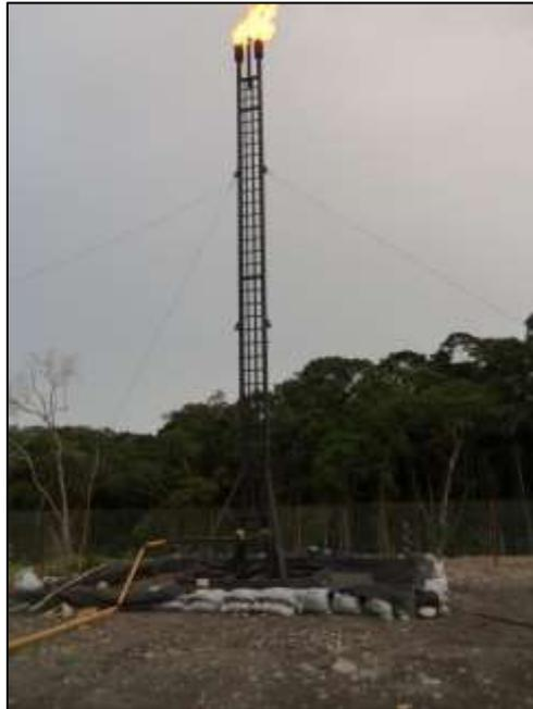
**FIGURA 2.17: Mechero de encendido manual**
