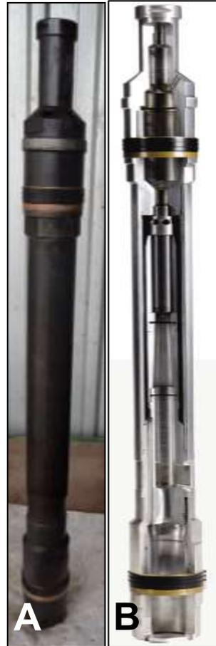
**FIGURA 1.8: Bomba Jet Claw Convencional en corte (A) y normal (B)**
