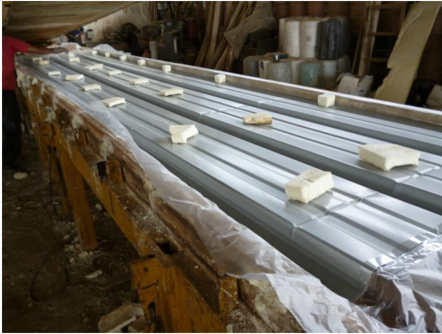
Fig. 3.5.- Poliuretano dispuesto en la lámina de superior para disponer la otra lamina inferior del panel sobre esta (Autor: Alfredo Bozano, José Vera)
