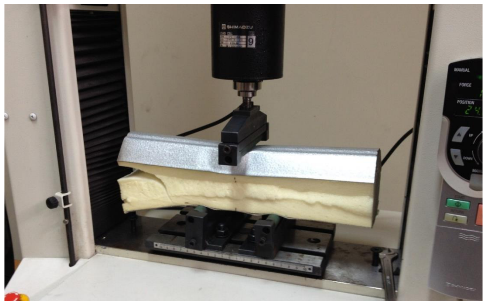
Fig. 4.4.- Falla del panel por cortante del núcleo (Autor: Alfredo Bozano, José Vera)
