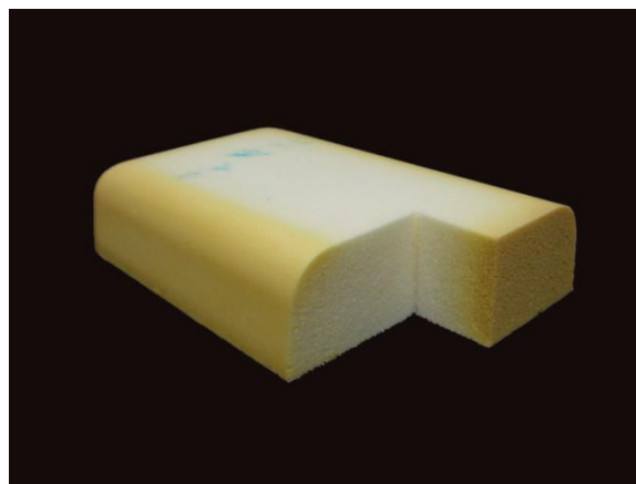
Fig. 2.6.- Pieza de espuma de poliuretano descolorida por la exposición a la luz ultravioleta. (Fuente: Cottontails, 2009)
