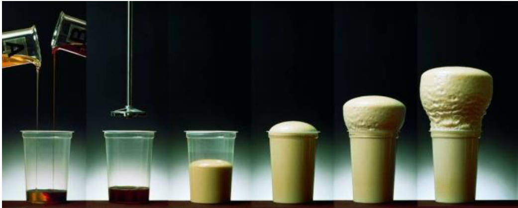
Fig. 2.3 .- Formación de espuma de poliuretano (Fuente: Christof Jelich, 2007)
