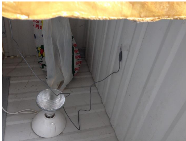
Fig. 4.14.- Fuente emisora de calor con la termocupla en contacto con la superficie del panel (Autor: Alfredo Bozano, José Vera)
