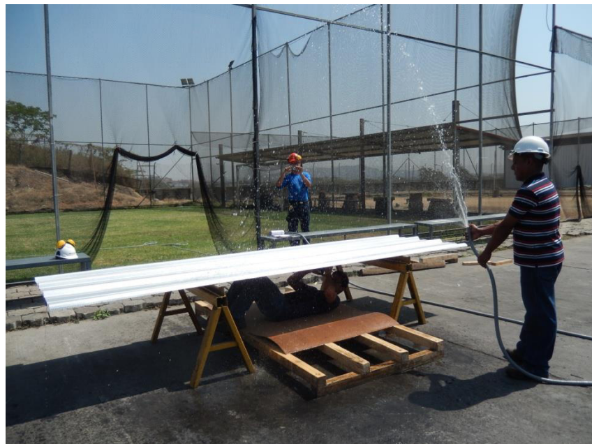
Fig. 4.17.- Ensayo de medición de ruido de lluvia simulada. (Autor: Alfredo Bozano, José Vera)
