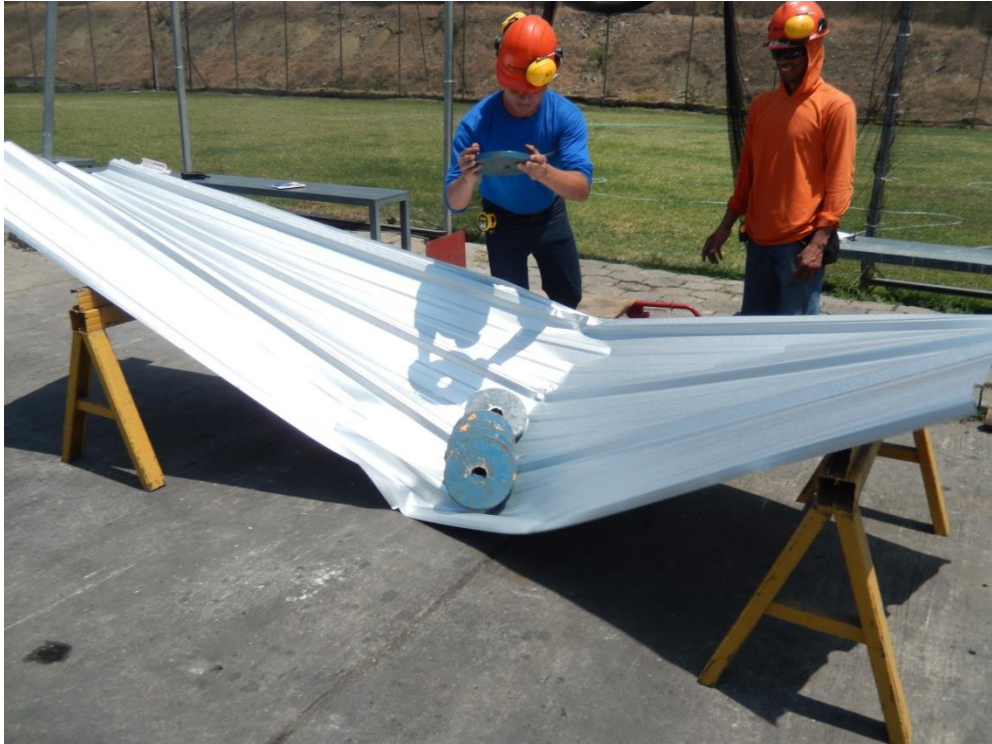
Fig. 4.8.- Falla de plancha galvalume 75.6 kg, luz libre 2.5 m (Autor: Alfredo Bozano, José Vera)
