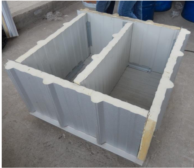
Fig. 4.12.- Caja de ensayo térmico (Autor: Alfredo Bozano, José Vera)
