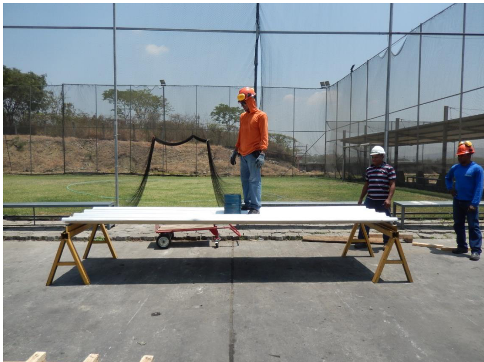
Fig. 4.7.- Prueba de carga (81.9 kg + persona de 59 kg) del panel mixto, luz entre apoyos 3.9 m. (Autor: Alfredo Bozano, José Vera)
