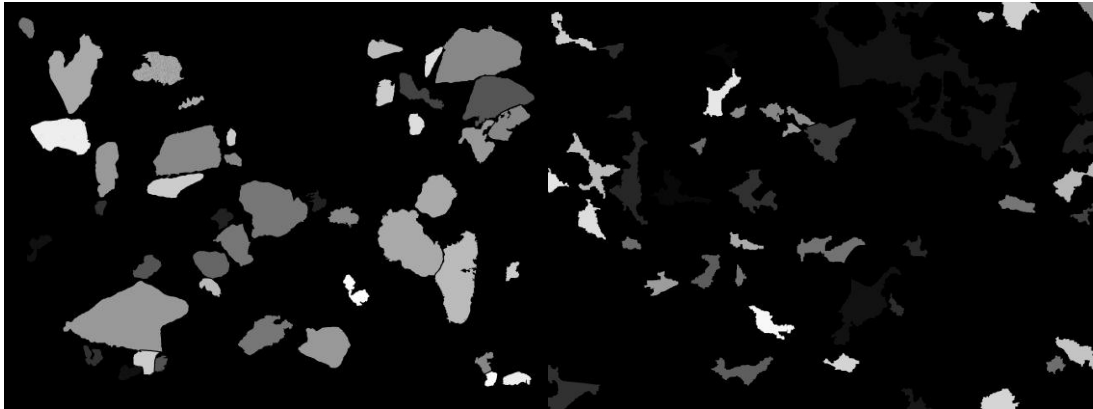
Figura 68. Bin producto de la segmentación de cuarzos (Izq.) y de poros (der.) de una escena de la muestra SI_9.
