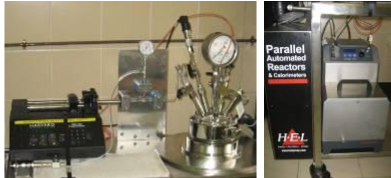
Figura 9. Bomba de CO 2 (Harvard Aparatus) y Sistema Regulador de Temperatura (Hel).
