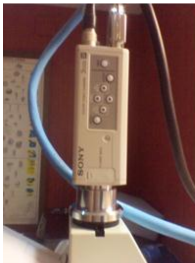
Figura 1. Cámara Sony 3CCD, acoplada al Microscopio Petrográfico.
