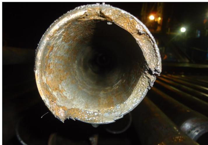
**FIGURA 5. 1: Corrosión en tubería**
