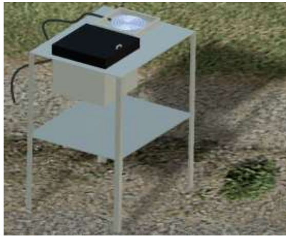
Figura 2.9. Prototipo experimental de la cocina solar híbrida.
