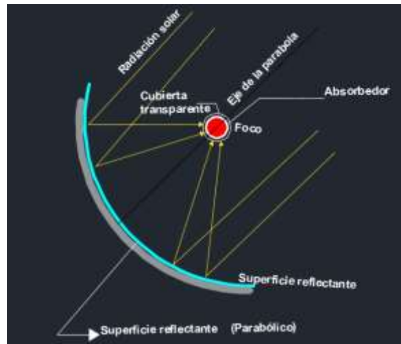
Figura 1.1 Esquema básico de un colector cilíndrico parabólico.
