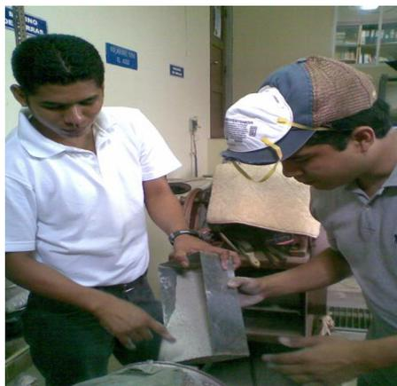
**FIGURA 3.4. AGREGAR ZEOLITA AL MOLINO DE RODILLOS**
