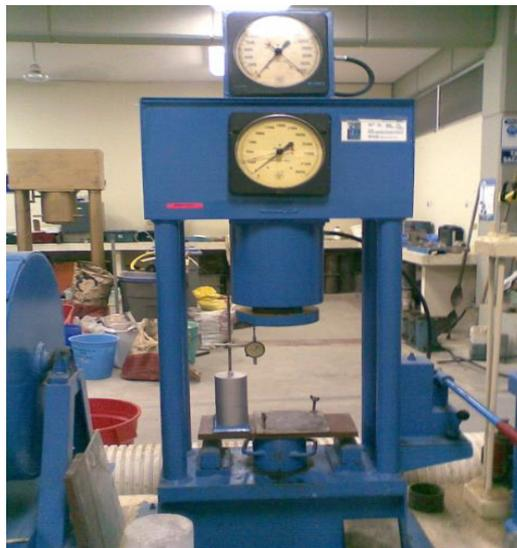
**FIGURA 3.24. MÁQUINA DE ENSAYOS UNIVERSAL**
