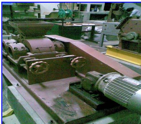
**FIGURA 3.3. MOLINO DE RODILLOS**
