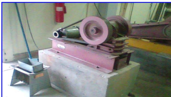
**FIGURA. 3.1 MOLINO DE MANDÍBULAS**
