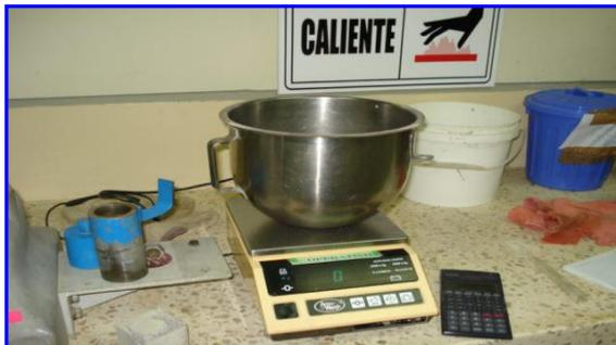
**FIGURA 3.14. BALANZA ELECTRÓNICA ENCERADA**
