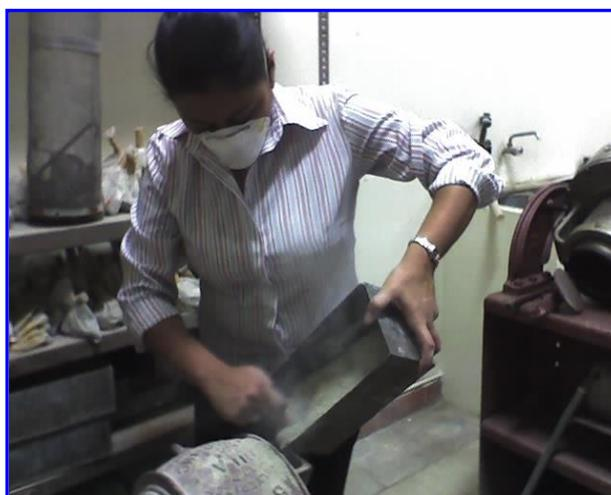
**FIGURA 3.8. AGREGANDO ZEOLITA AL MOLINO DE DISCOS**
