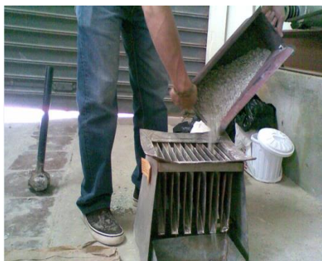
FIGURA 3.5. CUARTEO DE LA ZEOLITA
