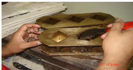
FIGURA 3.13. PREPARACION DE MOLDES
