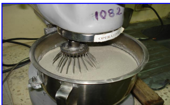
FIGURA 3.16. HOMOGENIZANDO CEMENTO + ZEOLITA
