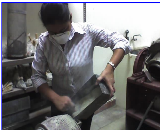
FIGURA 3.8. AGREGANDO ZEOLITA AL MOLINO DE DISCOS
