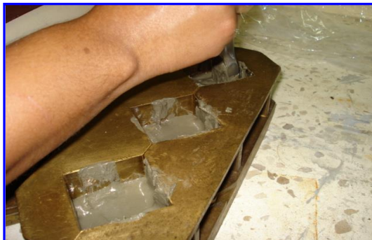
FIGURA 3.17. LLENANDO LOS MOLDES CON PASTA
