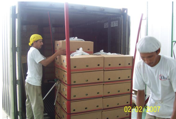
FIGURA 3.49: COLOCACIÓN DE ZUNCHOS EN NIVELES CON LA ENZUNCHADORA PARA TENSIONAR Y GRAPAR ZUNCHO
