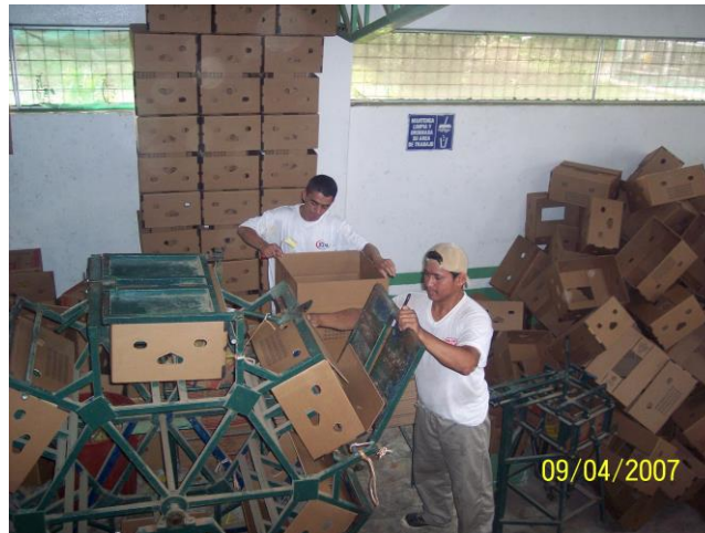
FIGURA 3.52: COLOCACIÓN DE GOMA EN BORDES DE CARTÓN Y COLOCACIÓN EN MÁQUINA PEGADORA NORMAL
