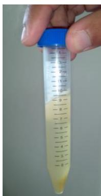
**FIGURA 4.70 RESINA EPÓXICA GE-60 + NANOARCILLA
