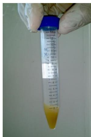
**FIGURA 4.50 RESINA EPÓXICA GE-38 + NANOARCILLA
