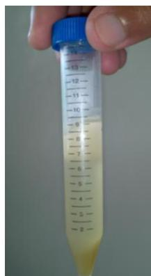
**FIGURA 4.71 RESINA EPÓXICA GE-60 + NANOARCILLA
