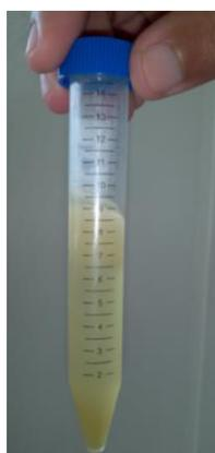
**FIGURA 4.61 RESINA EPÓXICA GE-60 + NANOARCILLA 20A
