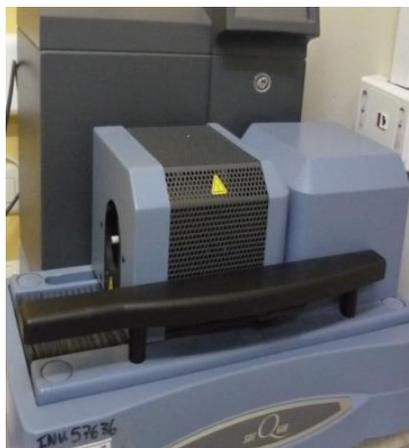
**FIGURA 3.20 ANALIZADOR TERMOGRAVIMÉTRICO SDT
