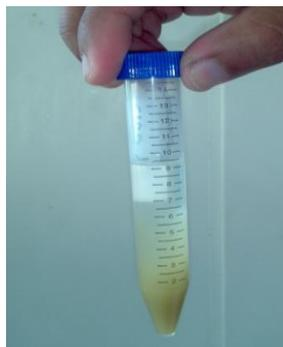
**FIGURA 4.51 RESINA EPÓXICA GE-38 + NANOARCILLA
