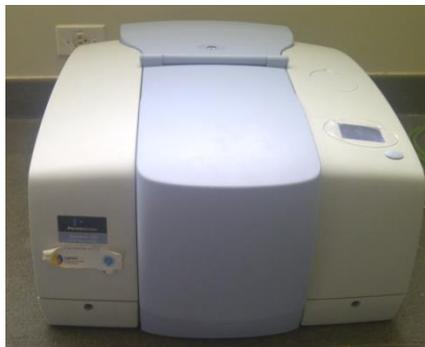
**FIGURA 3.19 ESPECTRÓMETRO DE RAYOS INFRARROJOS**
