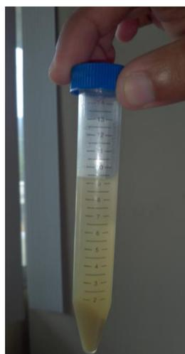
**FIGURA 4.73 RESINA EPÓXICA GE-60 + NANOARCILLA NA MINUTO 15.**
