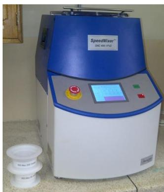
**FIGURA 3.18 EQUIPO SPEED MIXER (DAC 400.1 FVZ)**
