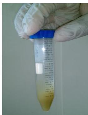
**FIGURA 4.52 RESINA EPÓXICA GE-38 + NANOARCILLA
