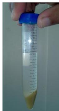
**FIGURA 4.55 RESINA EPÓXICA GE-38 + NANOARCILLA NA
