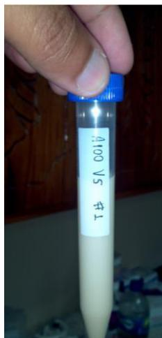
**FIGURA 4.72 RESINA EPÓXICA GE-60 + NANOARCILLA NA MINUTO 0.**
