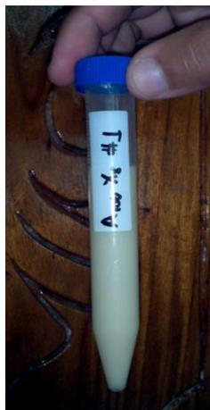
**FIGURA 4.57 RESINA EPÓXICA GE-60 + NANOARCILLA 20A
