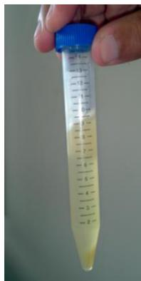
**FIGURA 4.69 RESINA EPÓXICA GE-60 + NANOARCILLA
