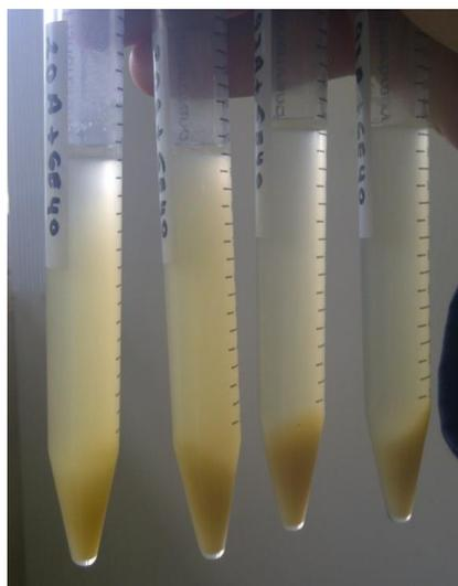
**FIGURA 4.100 RESINA EPÓXICA GE-40 + NANOARCILLA 20A,
