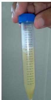
**FIGURA 4.66 RESINA EPÓXICA GE-60 + NANOARCILLA
