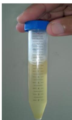
**FIGURA 4.59 RESINA EPÓXICA GE-60 + NANOARCILLA 20A
