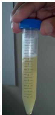
**FIGURA 4.63 RESINA EPÓXICA GE-60 + NANOARCILLA
