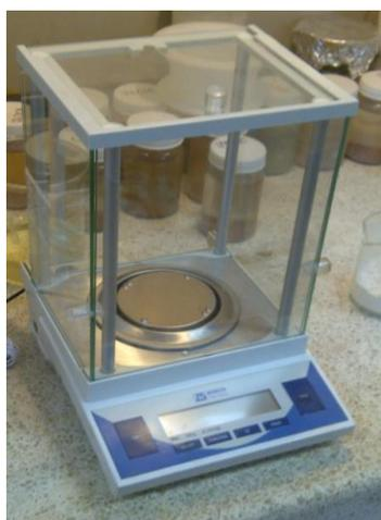
**FIGURA 3.15 BALANZA ANALÍTICA ELECTRÓNICA
