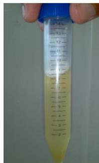
**FIGURA 4.60 RESINA EPÓXICA GE-60 + NANOARCILLA 20A
