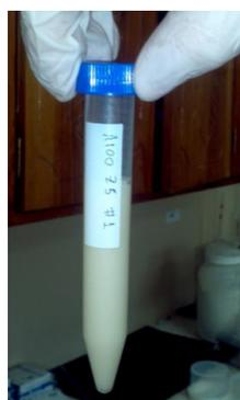
**FIGURA 4.67 RESINA EPÓXICA GE-60 + NANOARCILLA
