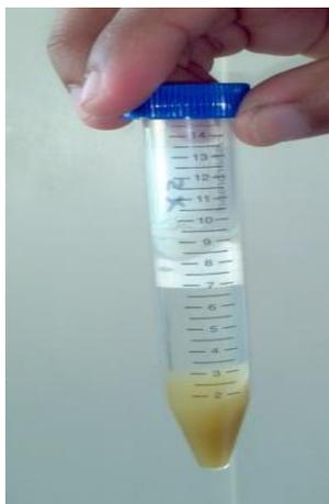
**FIGURA 4.49 RESINA EPÓXICA GE-38 + NANOARCILLA
