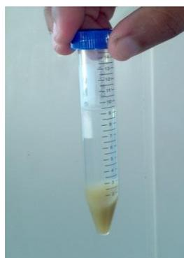
**FIGURA 4.53 RESINA EPÓXICA GE-38 + NANOARCILLA
