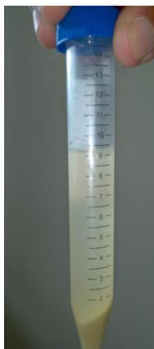
**FIGURA 4.75 RESINA EPÓXICA GE-60 + NANOARCILLA NA MINUTO 45.**
