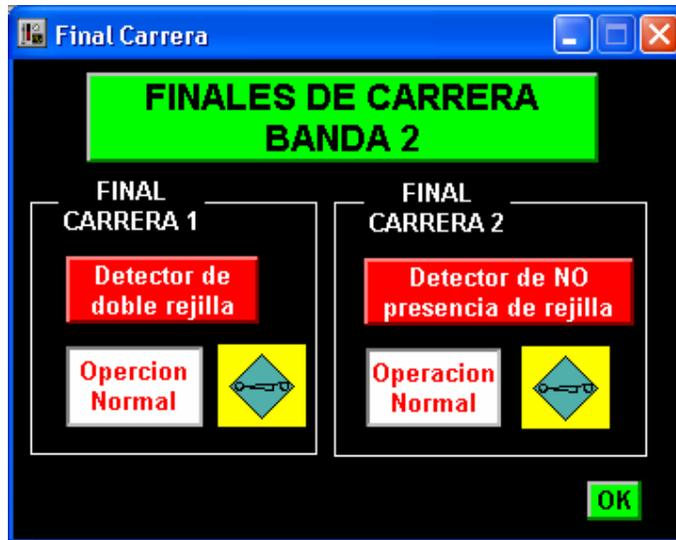
**Figura 2.11.** Pantalla que representa los finales de carrera en la banda transportadora 2.
