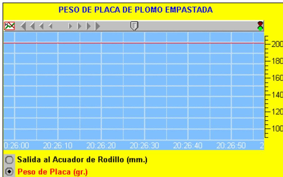
Figura 2. 32. Objeto *Hyper Trend* para el peso de la placa (rejilla de plomo).
