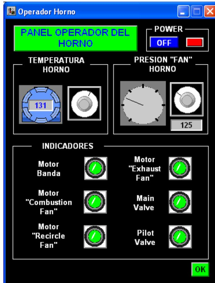
Figura 2. 15. Pantalla del panel de operador del horno.
