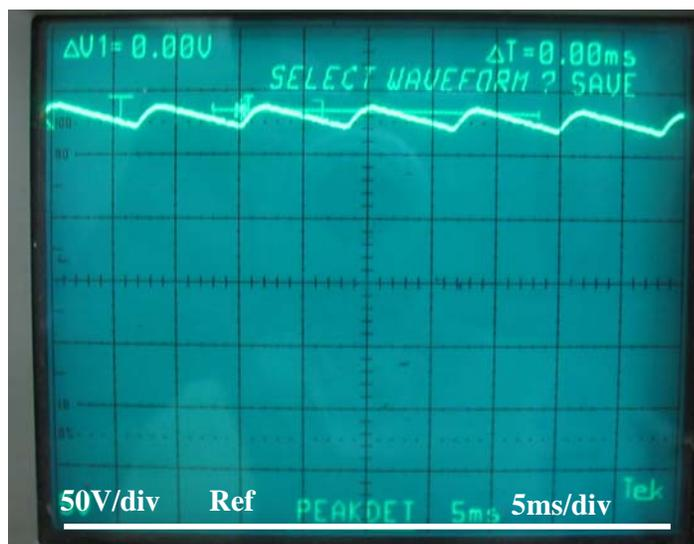
**FIGURA 5.53** Gráfica del rizado de los capacitores C1 y C2
