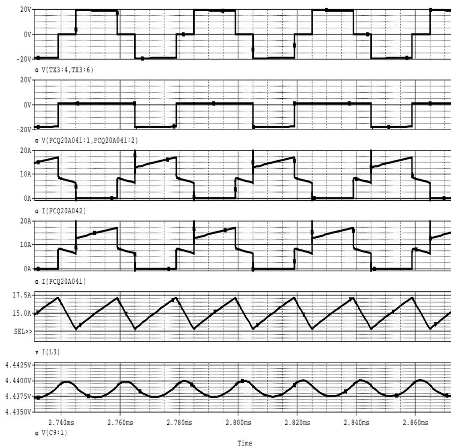
**FIGURA 5.36** Grafica del voltaje en el secundario, voltaje de uno del diodo, corriente de cada uno de los diodos, corriente de L3 y el voltaje de salida.
