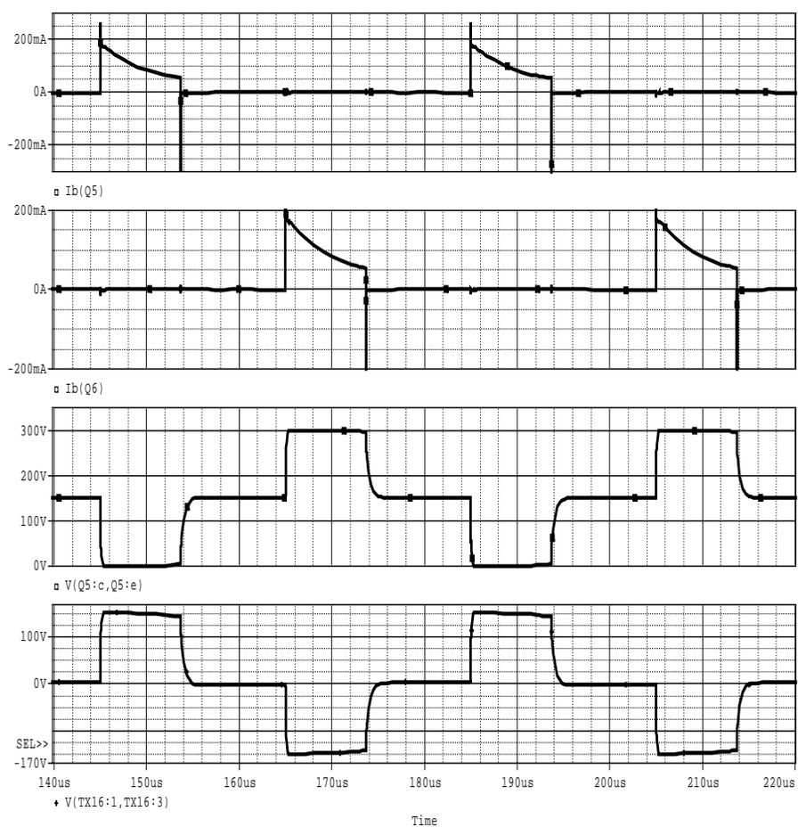
**FIGURA 5.34** Grafica de la corriente de base de cada transistor, el voltaje colector emisor de Q5 y el voltaje en el primario del transformador
