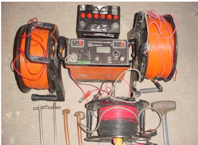
Fig. 6.8 Equipo de Geofísica Terrameter SAS 300 de la ESPOL, utilizado en la toma de los SEV's de este trabajo. Se aprecian el módulo principal, los carretes de emisión y recepción de corriente (de color naranja), carrete que mide la diferencia de potencial (en colores rojo y negro), la fuente de poder (batería de carro) y los electrodos de acero y cobre para los puntos A, B y M,N respectivamente (dispositivo Schlumberger).
