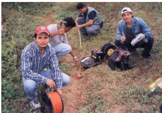
Fig. 6.10 Equipo de trabajo de sondeos eléctricos en operación
