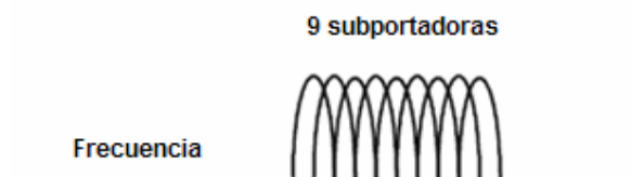
Figura 2.13: OFDM con nueve sub-portadoras
