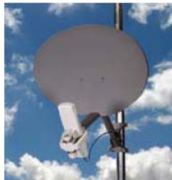
Figura 5.5: Backhaul con disco reflector
