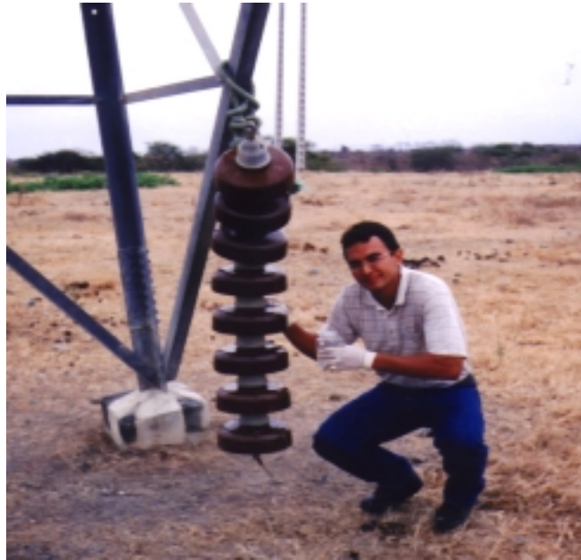
Figura 11.22 Recolección de muestras de la cadena de aisladores de suspensión ubicado en la Estructura # 180 del tramo Las Juntas – Posorja
