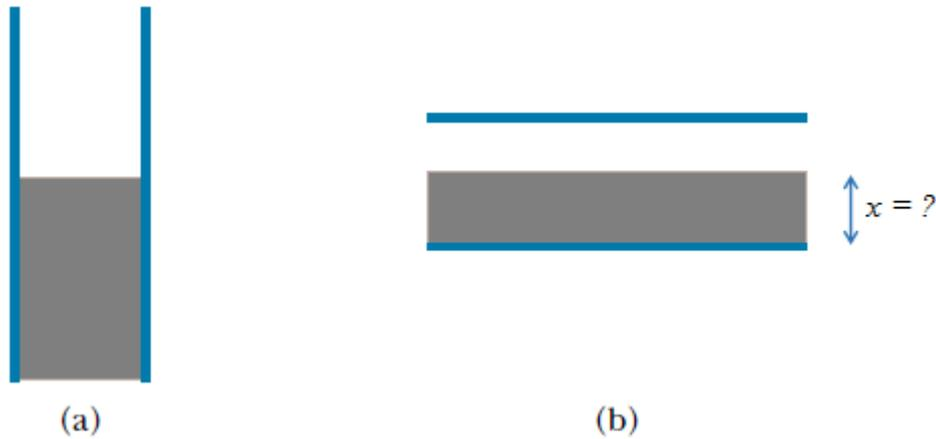
La orientación vertical establece dos capacitores en paralelo, con la capacitancia equivalente:
