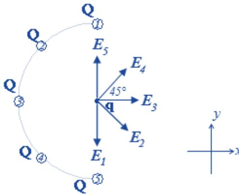
Por la simetría de las cargas, las componentes del campo eléctrico en el centro del semicírculo a lo largo del eje de las  $y$  se anulan.
