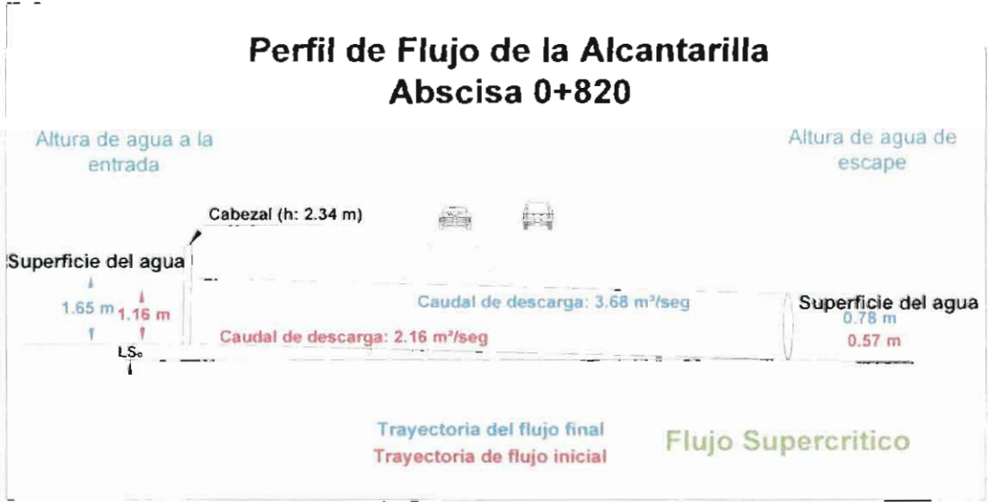
Figura 5.3.- Comportamiento hidráulico de las alcantarilla 0+820.
