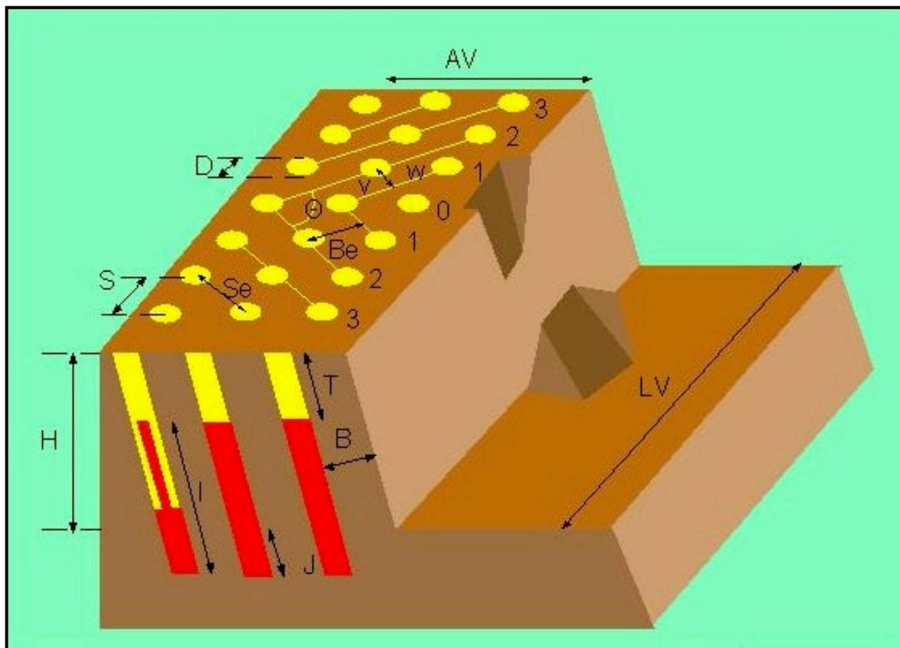
Fig. 4.3 Esquema de una voladura de banco
