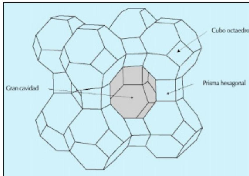
Fig. 3.1 Estructura Cristalina típica de una Zeolita
