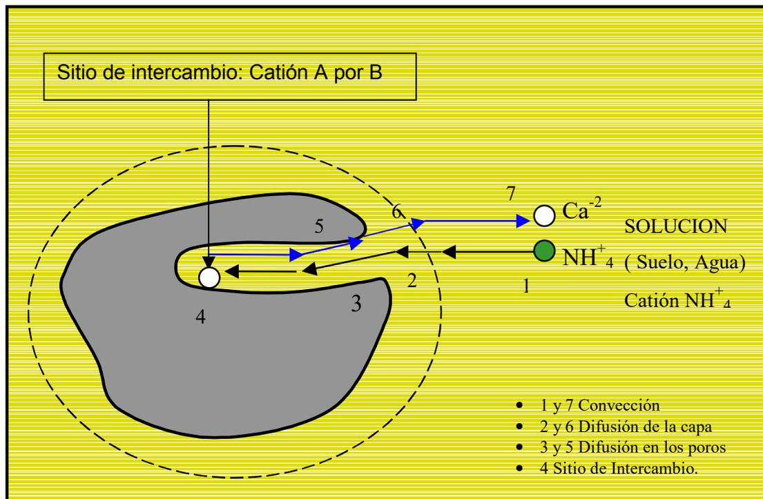
**Fig 3.5 Mecanismo cinético y selectivo de una zeolita**
