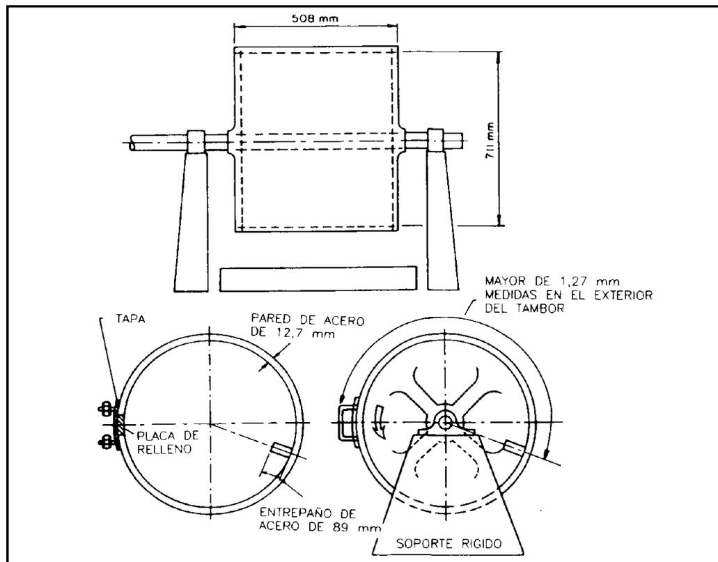
Fig 5.1 Máquina Los Ángeles para Ensayos de Abrasión
