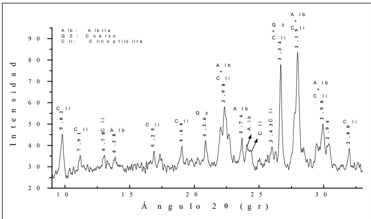
Fig. 3.25 Difractometría de una Lutita Tobácea de la Formación Cayo
