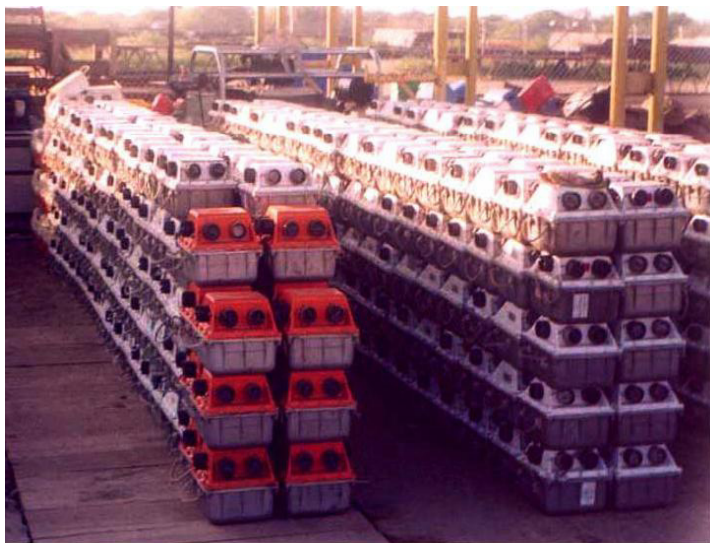
Figura 4.3.- Cajas telemétricas MRX (579 unidades).
