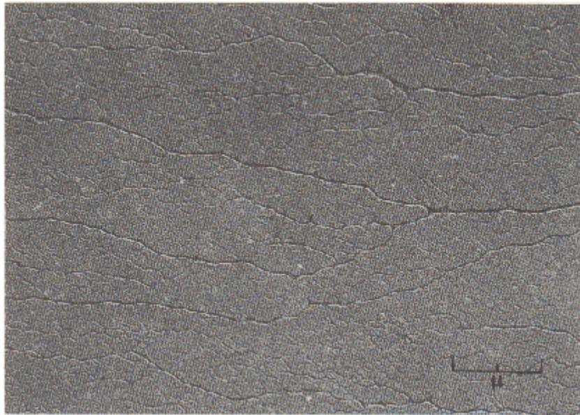
**MICROFOTOGRAFIA DE POLIACRILAMIDA DE ALTO PESO MOLECULAR CON 30% DE HIDRÓLISIS, EN AGUA DESTILADA, CONCENTRACIÓN 500 PPM**
