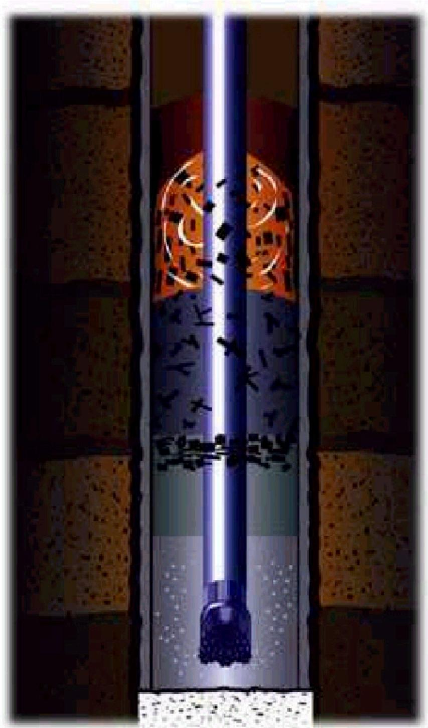
**FIG. 4.1 ESQUEMA DEL MOVIMIENTO TURBULENTO DE LOS RIPIOS**
