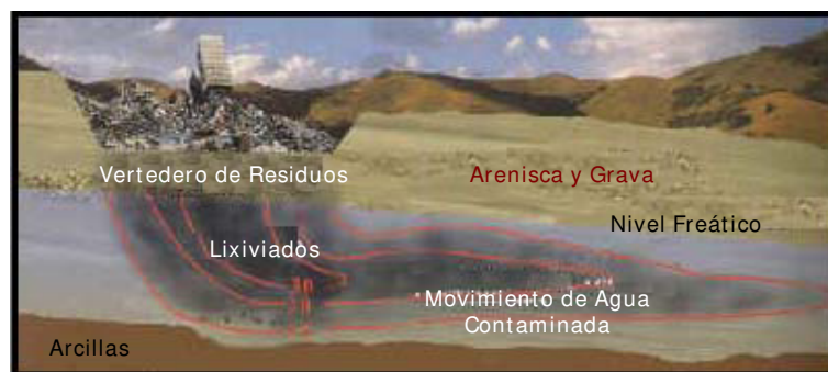
Figura 1.5 Gráfico general de penacho contaminante en un vertedero con fugas de lixiviado. Isocontenidos de amonio ( \text{NH}_4^+ ) en mg/l, http://www.miliarium.com
