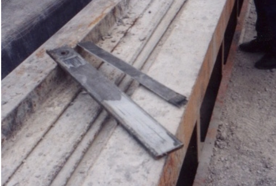
Foto 4.15. Falla Tipo a Tensión Ensayo Proyecto.
