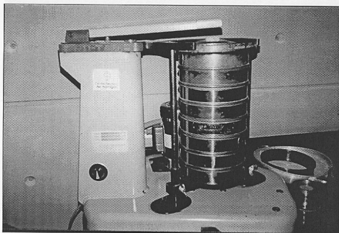
FOTO #2.- Tamizadora de Agregado Fino.
