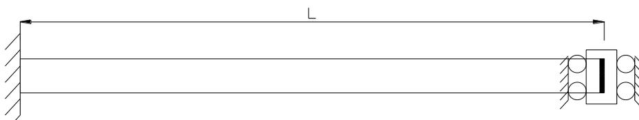
Confirme el resultado previamente mencionado, y, considerando las siguientes características, calcule la correspondiente frecuencia natural:  $E$ :  $2.11E10 \text{ kg/m}^2$ ,  $L$ : 5 m,  $B \times H$ :  $5 \times 5 \text{ cm}$ , y,  $\rho$ :  $7800 \text{ kg/m}^3$ . (30).
