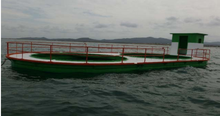
Figura 11: Plataforma marina de cultivo experimental de camarón Litopenaeus vannamei en mar abierto a 1 milla de la costa ecuatoriana en el sector de Engabao-Plavas.
