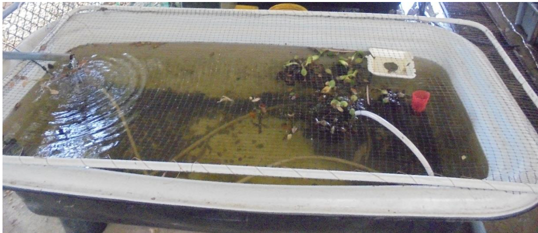
FIGURA 10. Tanque de 1000 L con sistema de flujos de agua.
