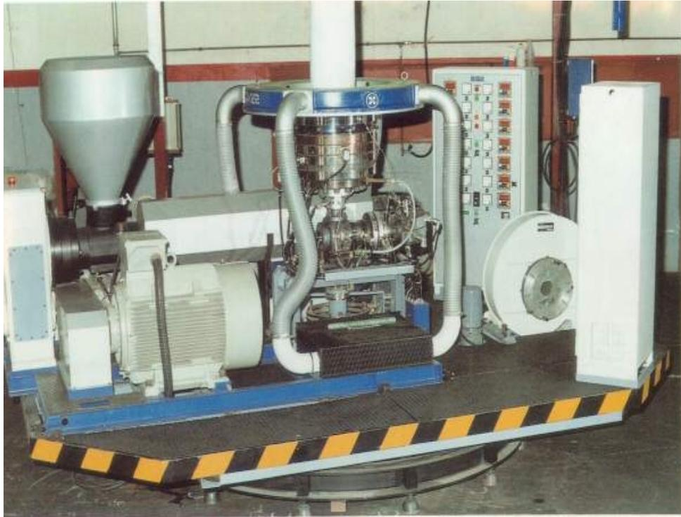
**FIGURA 1.1. EXTRUSORA EN FUNCIONAMIENTO**
