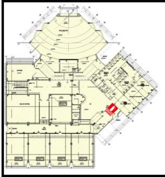
**Figura 4.4: Extintores, Planta baja, Edificio 19-A, Zona 3**
