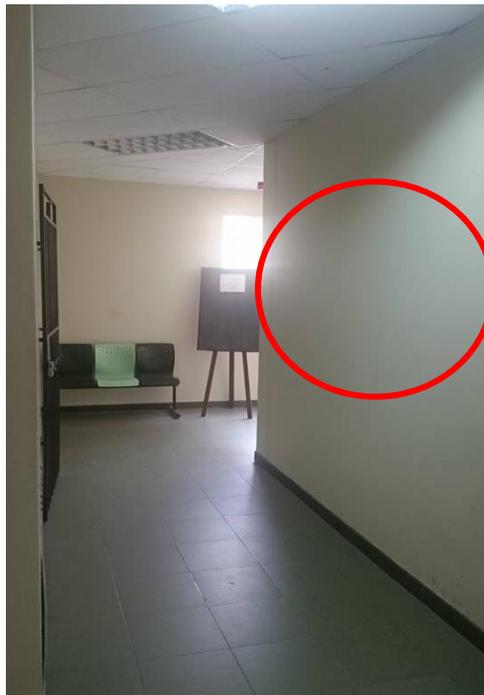
**Figura 2.3: Pasillos sin identificación de vías de evacuación**
