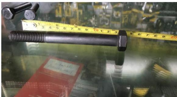
Figura 20: Perno de  $d=24\text{mm}$ ,  $L=100\text{mm}$ ; el cual va a ser utilizado en la placa del EJE PIVOTANTE.
