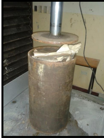
Figura 2.6. Ensayos de Compactación para el Cartón en el Laboratorio de Mecánica de Sólidos en la ESPOL.
