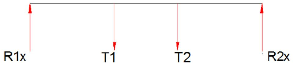
Figura 2.5 Diagrama de cuerpo libre del eje Y-Z.
