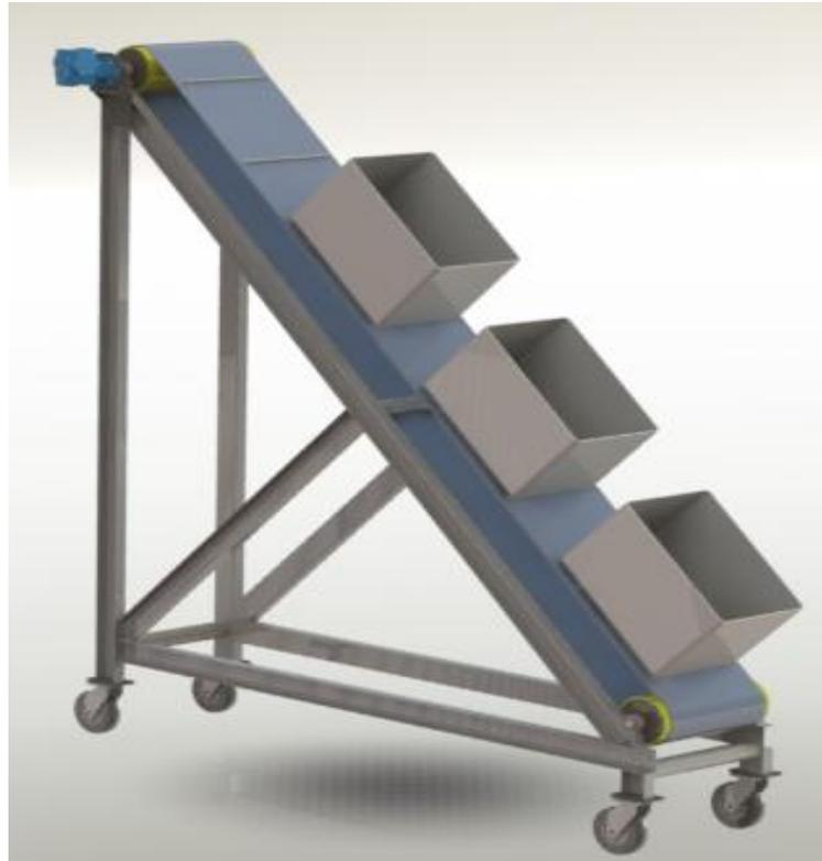
Figura 2.1 Diseño de forma de la banda transportadora
