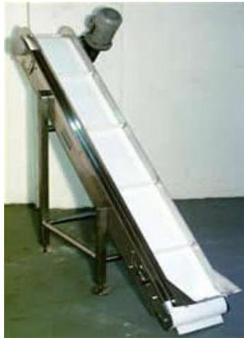
**Figura 1.3 Transportador Inclinado**
