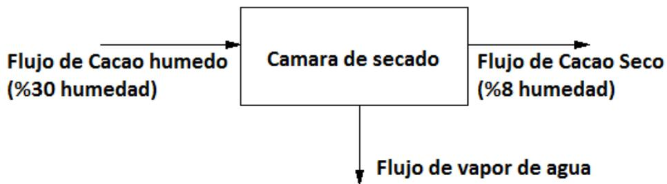
Figura 2.7.1 Esquema del balance de masa en la cámara de secado
