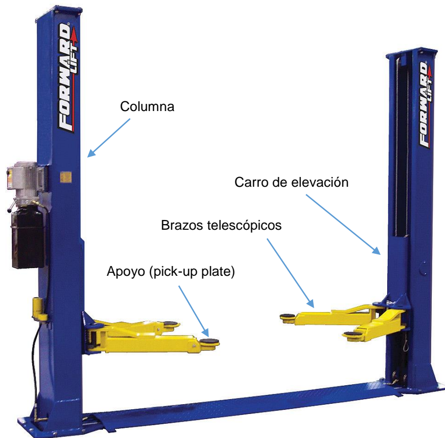
Figura 1.5 Elevador electro-hidráulico de dos columnas
