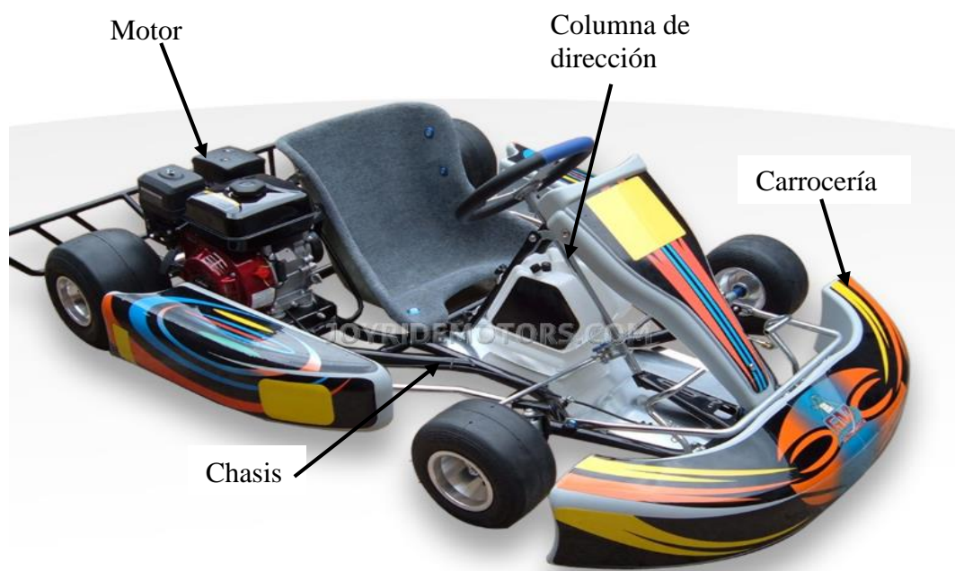
Figura 1.1. Componentes de un go-kart
