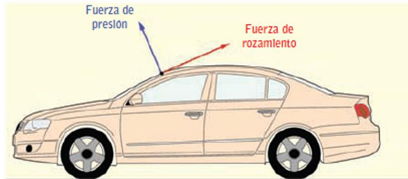
Figura 2.11 Fuerza de presión normal y de rozamiento presentes en un vehículo
