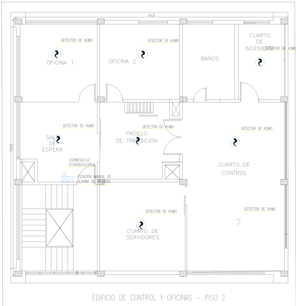
Figura N° 2-21 Sistema de detección en Piso 2 de Edificio de Control y Oficinas
