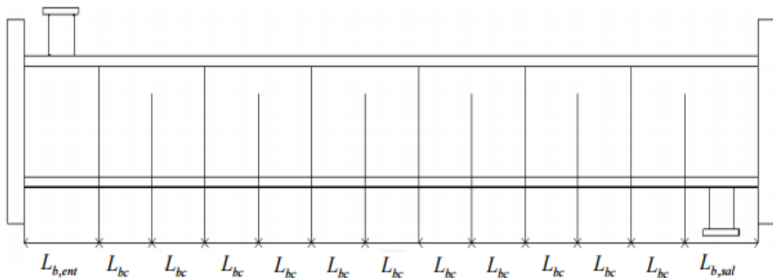
Figura 16. Esquema de la distancia de los desviadores de entrada, salida y centrales
