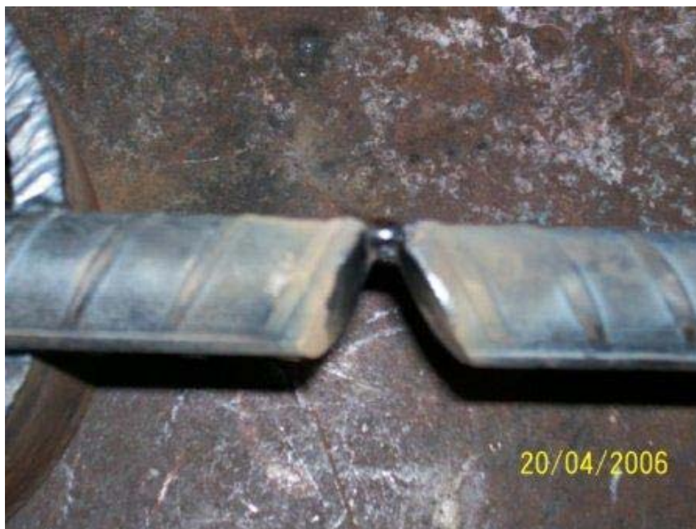
FIGURA. 3.2 ALINEACIÓN DE LA UNIÓN A TOPE EN V.
