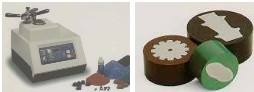
FIGURA. 1.22 PREPARACIÓN DE PROBETAS METALOGRAFÍAS, EQUIPO DE EMBUTICIÓN EN CALIENTE, Y MUESTRAS EMBUTIDAS.
