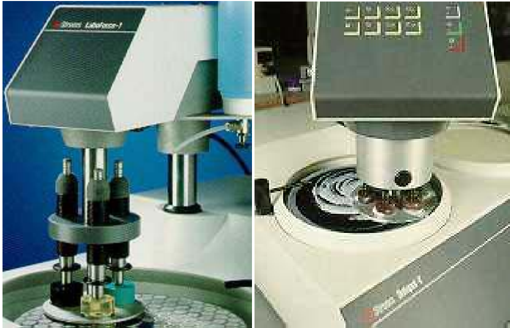
FIGURA. 1.23. EQUIPO DE DESBASTE MEDIANTE DISCO ABRASIVO, Y EQUIPO DE PULIDO SEMIAUTOMÁTICO CON PASTA DE ALÚMINA.
