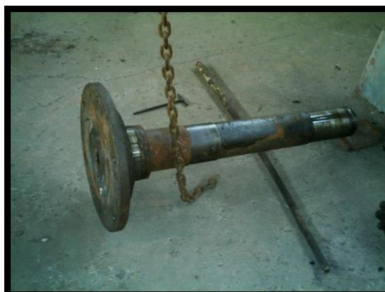
**FIGURA 1.4. EJE DESMONTADO DE LA BASE SUPERIOR**
