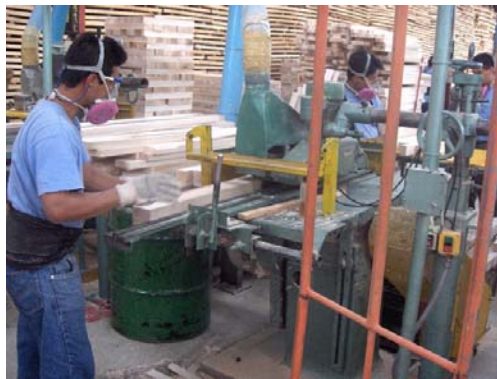
FIGURA 2.10. LIMPIEZA DE MADERA EN SIERRAS DE MESA
