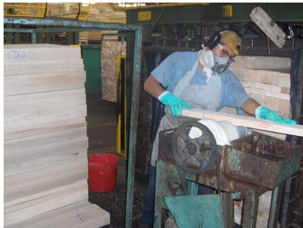
FIGURA 2.16 ENCOLAJE DE BLOQUE
