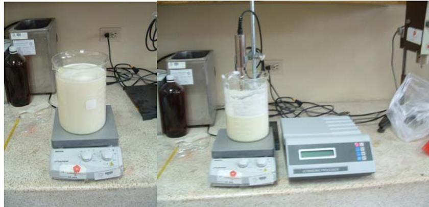
**FIGURA 3.9. AGITACIÓN CON PROCESADOR ULTRASÓNICO.**
